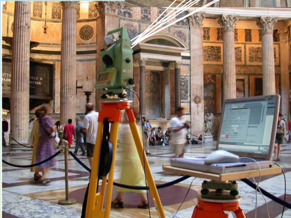
**Kontrolle der Geometrie der Kuppel durch die automatische Wiederholung der gesamten Messung in kürzester Zeit (geschätzte Dauer ca. 2,5 h)**
